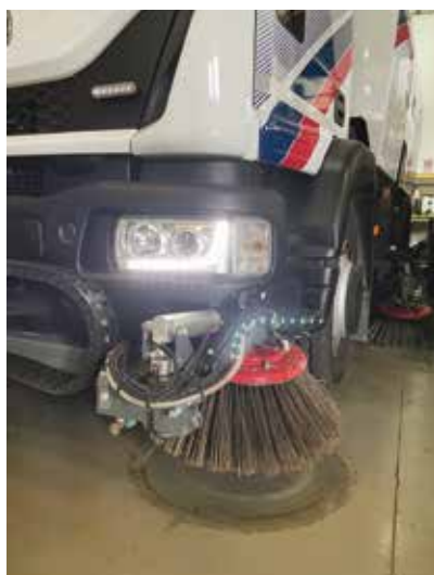
4. La spazzola laterale per la pulizia dei marciapiedi
