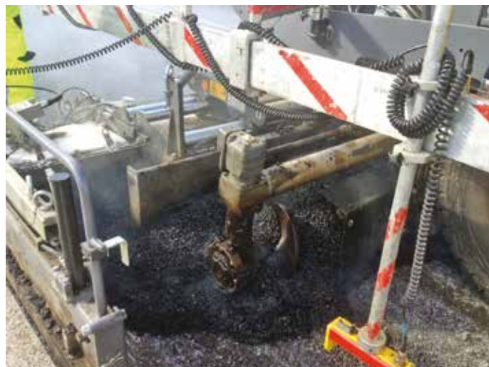
11 e 12. Il sistema di livellazione longitudinale integrato con tre punti di lettura su una barra di 13 m della vibrofinitrice Dynapac SD2500WS
